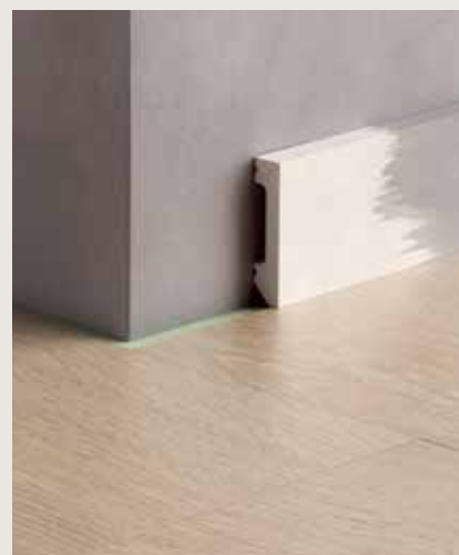
MÅLNINGSBAR VATTENTÅLIG MEDELSTOR GOLVSOCKEL 2400 x 13 x 58 mm Kan målas över eller lämnas vit. Använd Foamstrip och Aqua Sealant för en vattentät finish. Kärna: polystyren.
